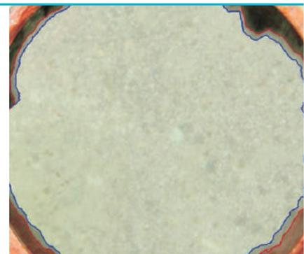
Nach der Installation von IOREX wurde die Skala deutlich reduziert
